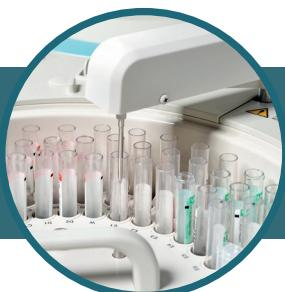
**Hemólise integrada para HbA1c: praticidade e agilidade.** Realiza até 626 testes/hora, com inserção prioritária de amostras emergenciais. Sondas individuais, mixer independente e preparo automático de hemolisado para HbA1c, reduzindo erros e otimizando tempo.
