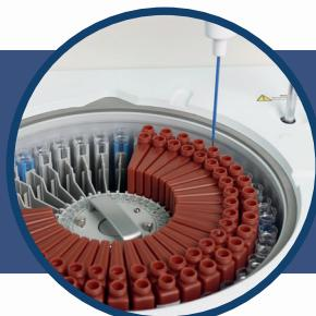
**Gran capacidad y una velocidad de 200 pruebas fotométricas por hora.** Dispone de 80 posiciones para reactivos en bandeja refrigerada, con lectura opcional de códigos de barras y gestión en tiempo real. La bandeja de muestras tiene 40 posiciones con acceso aleatorio integrado para análisis rutinarios y de emergencia.
