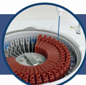
**Alta capacidade e velocidade de 200 testes fotométricos por hora.**
