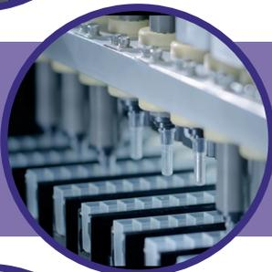
**Autonomía y flexibilidad.** El sistema utiliza muestras de sangre total, suero o plasma en 2 gradillas de muestras con 24 posiciones, que son compatibles con tubos primarios. Es posible realizar hasta 12 pruebas diferentes al mismo tiempo, cada una con diferentes tiempos o pasos de incubación.
