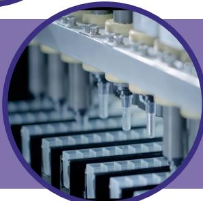
**Autonomia e flexibilidade em cada análise.** Compatível com amostras de sangue total, soro ou plasma, o sistema opera com 2 racks que acomodam até 24 tubos. Possui capacidade para realizar simultaneamente até 12 testes distintos, garantindo versatilidade e alta produtividade em diferentes rotinas laboratoriais.
