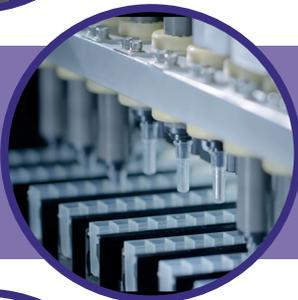
**Autonomia e flexibilidade.** O sistema utiliza amostras de sangue total, soro ou plasma em 2 racks de amostras com 24 posições, que são compatíveis com tubos primários. É possível realizar até 12 testes distintos ao mesmo tempo, cada um com diferentes tempos ou etapas de incubação.
