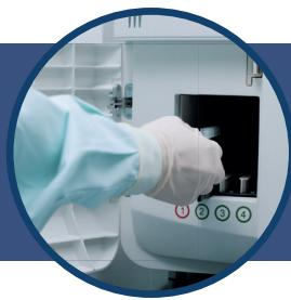
Analizador de mesa de diseño compacto y 100% automático para realizar hasta 120 pruebas/hora. Capacidad de hasta 24 posiciones para muestras y 15 posiciones refrigeradas para reactivos. Función STAT y suministro continuo de muestras, reactivos y consumibles sin necesidad de parar la rutina del equipo.
