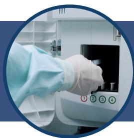
Analisador de bancada com design compacto e 100% automático para execução de até 120 testes/hora. Capacidade de até 24 posições para amostras e 15 posições refrigeradas para reagentes. Função STAT e abastecimento contínuo de amostras, reagentes e consumíveis sem a necessidade de parar a rotina do equipamento.
