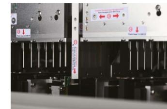
Estación de lavado con sistema de limpieza en dos etapas, compuesto por seis agujas, asegurando una alta eficiencia y reducción de tiempo.
