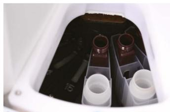
Puede cargar y descargar en cualquier momento, con escaneo de código de barras, refrigeración y alarma de temperatura de tiempo de real.
