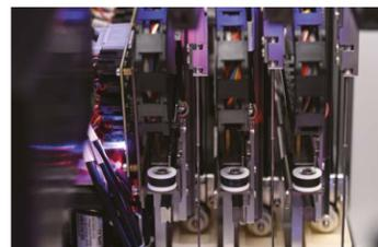
Adición de reactivos y muestras de forma independiente, optimizando el procesamiento de las pruebas. Utiliza diferentes esquemas de lavado de agujas, reduciendo eficazmente la tasa de contaminación residual.
