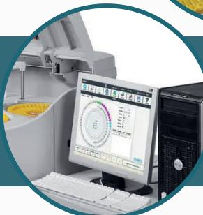
**Excelente desempeño y precisión.** Evaluación automática de cubetas reactivas, garantizando una adecuada limpieza. Lavado eficiente de las cubetas. 12 longitudes de onda (340 a 800 nm). Función de preparación de hemolizado integrada para HbA1c, sin necesidad de centrifugar la muestra. Consumo de aproximadamente 25 litros/hora.
