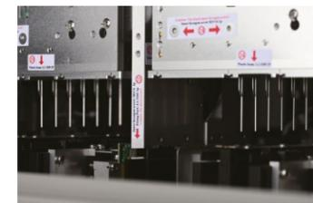
Estação de lavagem com sistema de limpeza em duas etapas, composta por seis agulhas garantindo alta eficiência e redução de tempo.
