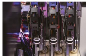
Adição de reagentes e amostras de forma independente, otimizando o processamento do teste. Utiliza esquemas de lavagem da agulha diferentes, reduzindo efetivamente a taxa de contaminação residual.
