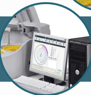
**Excelente desempenho e precisão.** Checagem automática das cubetas de reação, assegurando limpeza adequada. Lavagem eficiente das cubetas. 12 comprimentos de onda (340 a 800 nm). Função de preparo on-board do hemolisado para HbA1c, sem a necessidade de centrifugação da amostra. Consumo de aproximadamente 25 litros/hora.
