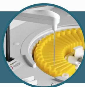
**Economia de tempo e confiabilidade.** Velocidade constante de 400 testes/hora com ISE opcional, somando a velocidade máxima de 800 testes/hora. Sondas individualizadas para reagente e amostras, com homogeneização por mixer. Acesso randômico com 115 posições de amostras e sensor de nível nas probes de amostra e reagentes, conferindo maior sensibilidade e minimizando a interferência de bolhas.
