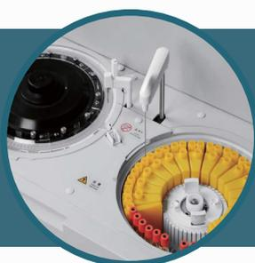
**Alta productividad con acceso aleatorio.** Analizador químico clínico con una velocidad de 240 pruebas fotométricas/hora y 480 pruebas/hora combinado con un módulo ISE (opcional), favoreciendo la rapidez en la ejecución de rutinas de laboratorio. Capacidad de hasta 80 posiciones de reactivos con lector de código de barras incorporado (optativo). Acceso aleatorio integrado para análisis de rutina y de emergencia.
