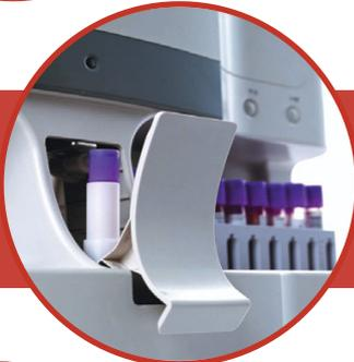
**Alta produtividade e dinamismo.** Baixo consumo de reagentes, velocidade de até 60 amostras por hora com possibilidade de inserção de amostra de emergência com carregamento automático.
