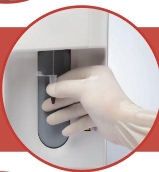
**Bajo consumo de muestra y más ahorro.** Utiliza un volumen de muestra reducido, minimizando las tomas de muestra y ofreciendo un mejor desempeño. Utiliza 15 µL de muestra en el modo Sangre total y 20 µL en el modo Prediluido. Relación de dilución en modo prediluido superior a otros analizadores del mismo tamaño, promoviendo un excelente desempeño.
