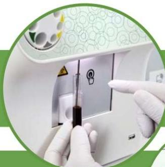
O Aud-H Vet permite, através da metodologia de impedância, a análise precisa e exata de 19 parâmetros, com contagem de glóbulos brancos em diferencial de 4 partes (linfócitos, monócitos, granulócitos e eosinófilos) para amostras caninas, felinas e equinas.
