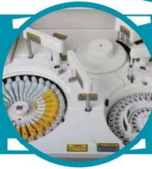
**Eficiência e economia.** O analisador trabalha com um volume reduzido de reação (no mínimo 150 µL), maximizando o rendimento do reagente. As 90 cubetas do Labmax 560 são de vidro (Pyrex®). Duráveis e com baixíssima frequência de trocas, são uma alternativa na redução dos custos laboratoriais.
