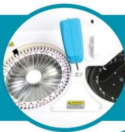
O Labmax Plenno é um analisador automático programado para realizar testes bioquímicos e turbidimétricos em uma mesma rotina. Realiza até 300 testes fotométricos/hora. As cubetas de reação são lavadas automaticamente, agilizando a rotina e diminuindo os riscos de contaminação.
