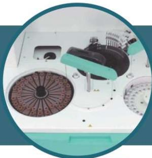
**Eficiência e produtividade.** Realiza por hora 270 testes fotométricos e a produtividade pode chegar até 450 testes associados ao módulo ISE (opcional). São 36 posições para reagentes em bandeja refrigerada, dotada de leitor de código de barras e controle do nível de líquido. A bandeja de amostras possui 30 posições para amostras e outras 15 para calibradores, controles e amostras de urgência. Acomoda tubos primários (de coleta) ou cubetas específicas.
