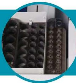
Bandeja refrigerada para 28 reagentes, frascos de 5 e 15 mL. Detector de nível para reagentes, controles e calibradores, que faz a checagem antes do início da rotina. A bandeja de amostras conta com 20 posições (calibradores, controles e emergências) para tubos primários ou cubetas.
