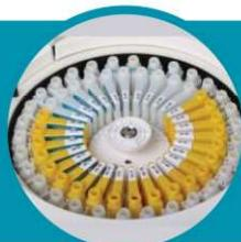
**Produtividade e estabilidade.** O Labmax 560 possui velocidade nominal de 560 testes/hora com ISE. Possui bandeja refrigerada, o que garante estabilidade dos reagentes on board. A bandeja conta com 60 posições para a execução de testes bioquímicos e imunoquímicos simultâneos em uma mesma rotina.
