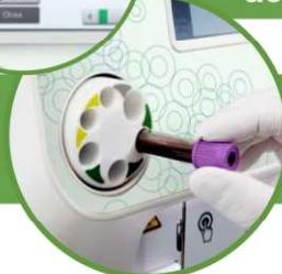
Homogeneizador de amostra embutido. A sonda para aspiração de amostra conta com limpador automático que mantém o sistema livre de acúmulo de proteínas e crescimento bacteriano.
