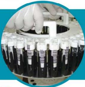
**Segurança e autonomia.** A bandeja de amostras é móvel e possui 72 posições para cubetas plásticas ou tubos primários e 20 posições internas para calibradores e controles. Possui sonda exclusiva para amostras, evitando contato com os reagentes, minimizando as chances de contaminações cruzadas.
