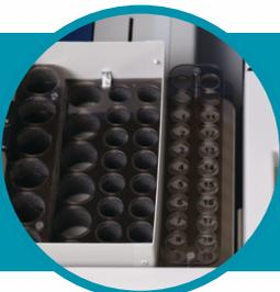
Bandeja refrigerada para 28 reagentes, frascos de 5 e 15 mL. Detector de nível para reagentes, controles e calibradores, que faz a checagem antes do início da rotina. A bandeja de amostras conta com 20 posições (calibradores, controles e emergências) para tubos primários ou cubetas.
