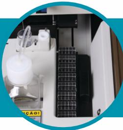
O analisador tem velocidade nominal de até 100 testes/hora. Processa reações cinéticas e ponto final; Cubetas de resina óptica descartáveis. Armazena os valores de controles, podendo ser visualizados graficamente (Levey-Jennings).
